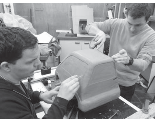
Entwurf der Karosserie eines rollstuhlgerechten Stadtautos
