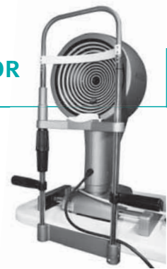
Sirius der Firma bon Optic, zur Radienmessung am Auge, ein Leih-Gerät des Herstellers
